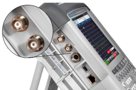
Beide BNC-Anschlüsse können für verschiedene Anwendungen konfiguriert werden. Die Namen der Anschlüsse sind auf den Innenseiten der Schutzkappen eingepreßt.
